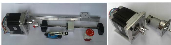
Figura 2: Equipos para construcción de mesas vibratoras
