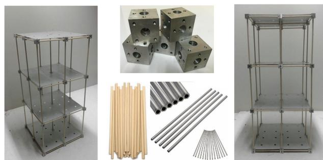
Figura 1: Piezas de unión y maqueta de pórticos.
