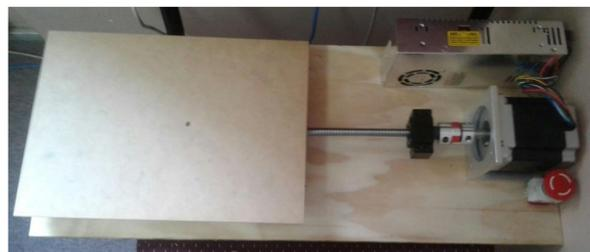
Figura 4: Mesa vibradora mediana con motor stepper y corriente 220V. Reproduce cualquier movimiento en 1D.
